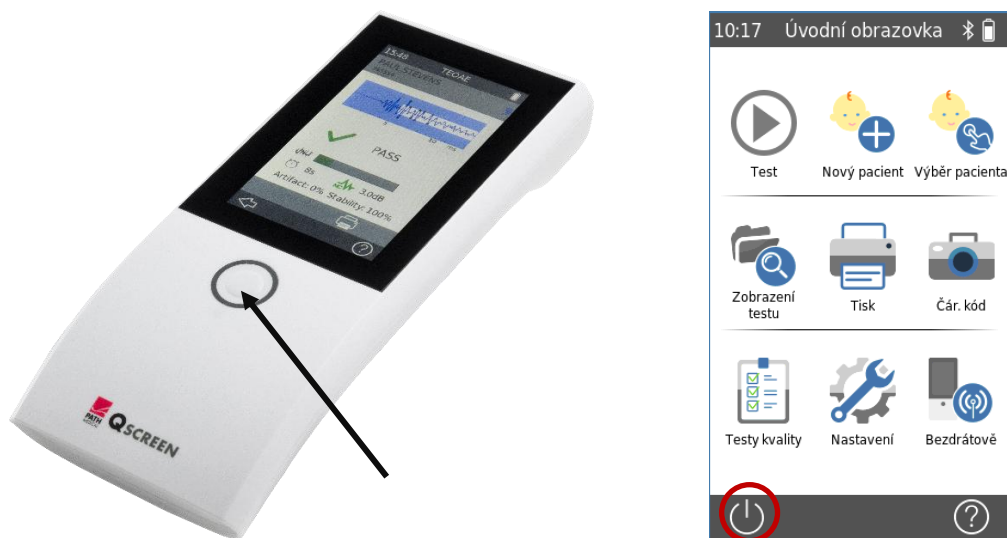
Obrázek 3: Spínač zapnuto / vypnuto (vlevo: spínač zapnuto / vypnuto zařízení, vpravo: tlačítko Power na obrazovce)
