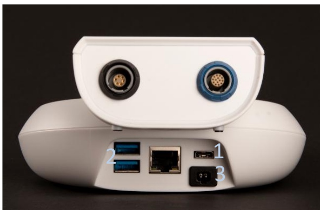
Obrázek 4: Zdiřky zařízení QSCREEN (nahore), zdiřky dokovací stanice (dole)
