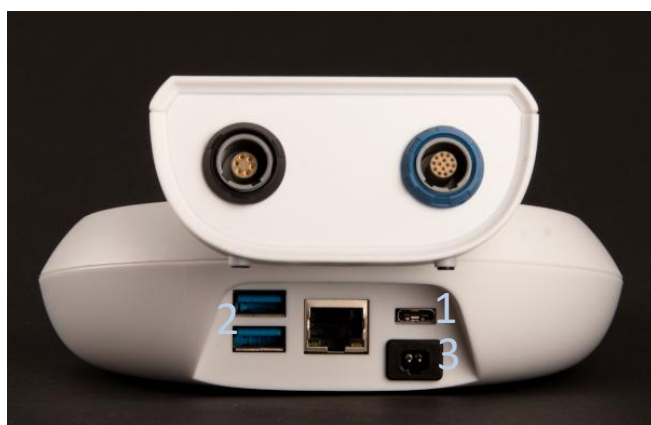
Figura 4: prese DISPOSITIVO QSCREEN (superiore), prese docking station (inferiore)
