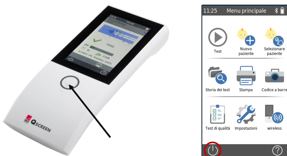
Figura 3: interruttore accensione/spegnimento (sinistra: interruttore di accensione/spegnimento dispositivo, destra: pulsante Alimentazione schermata)
