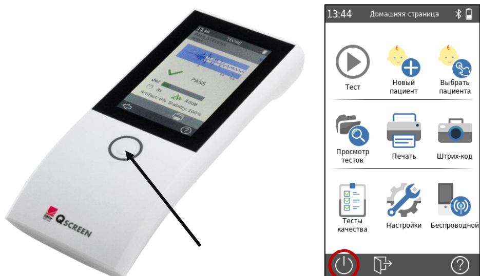
Рисунок 3: Переключатель вкл./выкл. (слева: переключатель вкл./выкл. (для включения/выключения устройства), справа: кнопка питания на экране)
