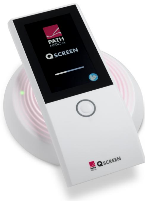
Рисунок 5: Индикаторная лампа зарядки на базовой станции
