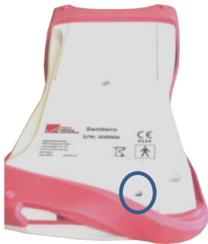
Εικόνα 3: Κουμπί επαναφοράς συσκευής για φορητή συσκευή
