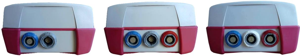
Figure 4: Panneau de prises de périphériques de l'appareils portables (de gauche à droite: Senti, Sentiero, Sentiero Advanced)
