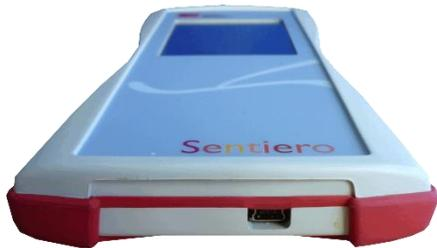
Figure 5: Prise USB de l'appareil portable
