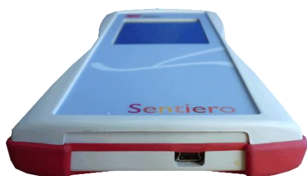
Figura 5: Presa USB di dispositivo handheld
