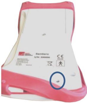
Afbeelding 3: Apparaat resetknop voor mobiel toestel
