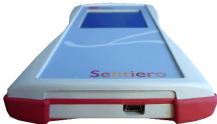
Afbeelding 5: USB-aansluiting van mobiel toestel
