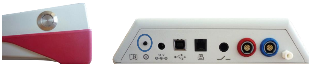
Afbeelding 2: Aan/uit schakelaar voor mobiele (links) en desktop apparaten (rechts, gemarkeerd met blauwe cirkel)
