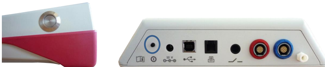
Figura 2: Çelësi i ndezjes/fikjes për pajisjen e dorës (majtas) dhe desktop (djathtas, i shënuar me rreth blu)
