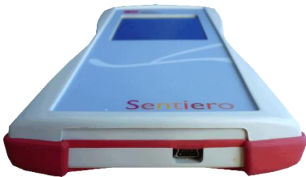
รูปที่ 5: ซี็อกเก็ต USB ของรุ่นที่พกพาได้
