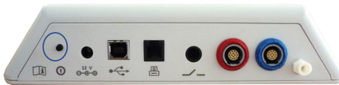
รูปที่ 2: สวิตช์เปิด/ปิดสำหรับรุ่นที่พกพาได้ (ซ้าย) และรุ่นตั้งโต๊ะ (ขวา ทำเครื่องหมายด้วยวงกลมสีน้ำเงิน)
