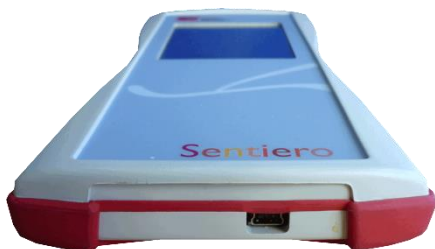
Şekil 5: El cihazının USB soketi
