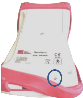
Şekil 3: El cihazları için cihaz resetleme butonu
