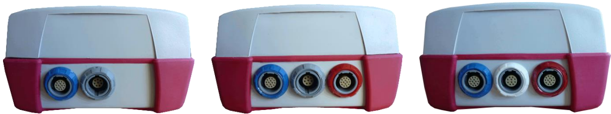
Şekil 4: El cihazlarının soket paneli (soldan sağa: Senti, Sentiero, Sentiero Advanced)
