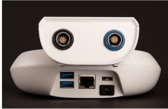
Figure 4 : Prises pour appareils QSCREEN (en haut), prises pour station d'accueil (en bas)
