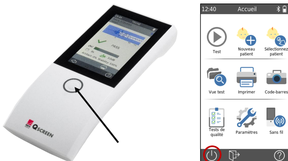
Figure 3 : Interrupteur marche/arrêt (à gauche : interrupteur marche/arrêt de l'appareil, à droite : bouton d'alimentation de l'écran)
