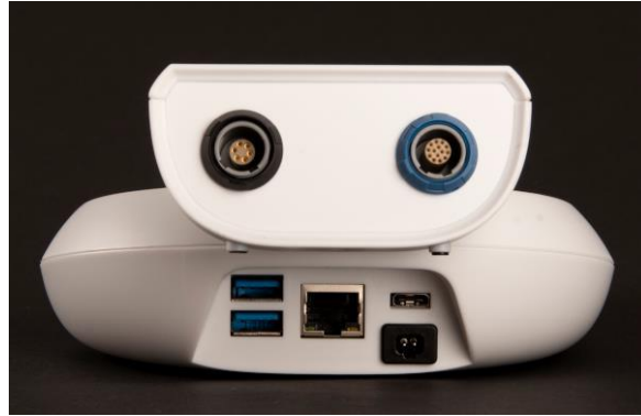
Figure 4 : Prises pour appareil QSCREEN (en haut), prises pour station d'accueil (en bas)
