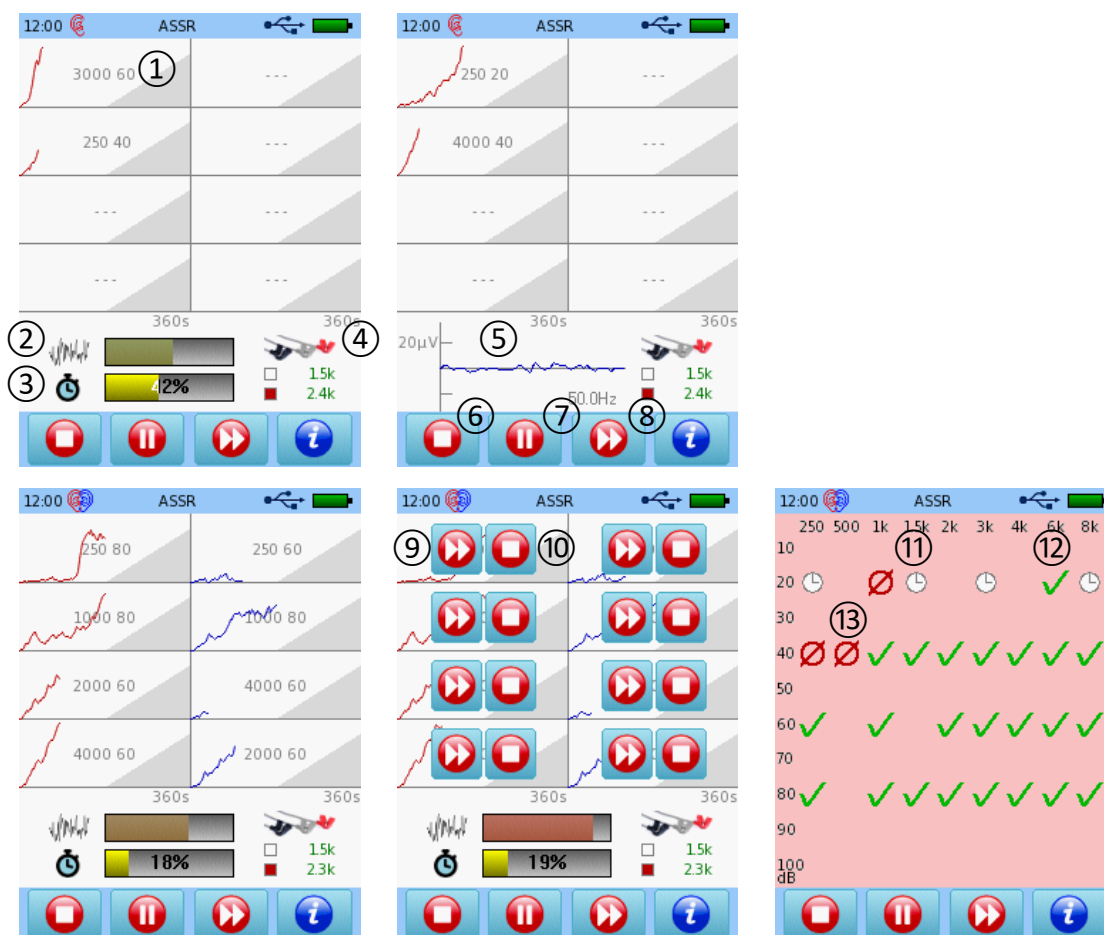
Rys 62: Pomiar ASSR (u góry - jednuszny pomiar 40 Hz ASSR; u góry po lewej - standardowy ekran pomiaru; u góry po prawej - ekran pomiaru z wykresem szumu EEG; u dołu - dwuszny pomiar ASSR 80 Hz; u dołu po lewej - standardowy ekran pomiaru; dolny środkowy - pomiń / zatrzymaj wybór; prawy dolny róg - status pomiaru i macierz wyników)
