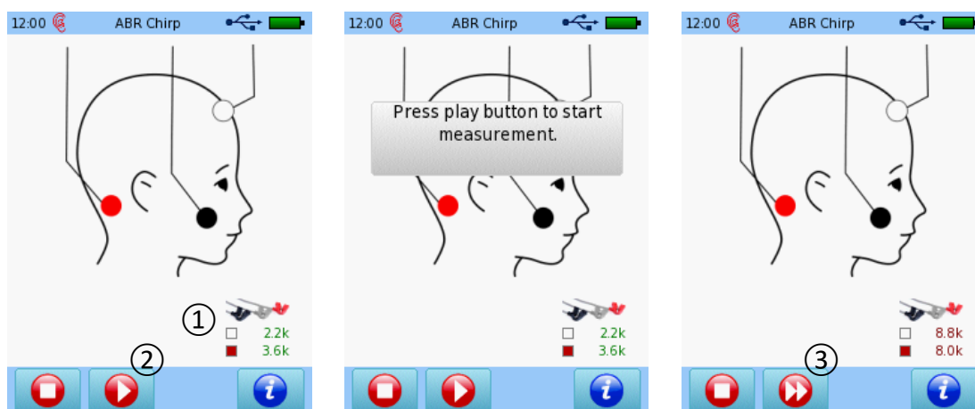
Rys 49: Pomiar impedancji ABR (po lewej - dobre impedancje z przyciskiem odtwarzania; w środku - dobre impedancje z przyciskiem odtwarzania i przypomnienie o rozpoczęciu testu przez naciśnięcie przycisku odtwarzania; po prawej - słabe impedancje)
