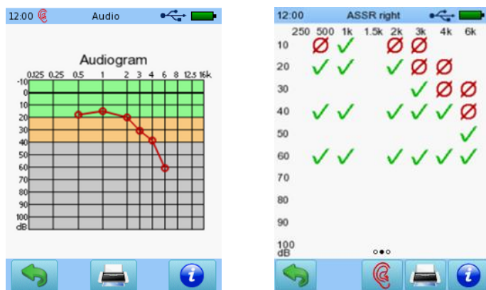
Rys 65: Przykłady przypadków ASSR (lewy górny / dolny - progi behawioralne uzyskane w audiometrii tonalnej; prawy górny - progi ASSR; prawy dolny - macierz stanu odpowiedzi ASSR)
