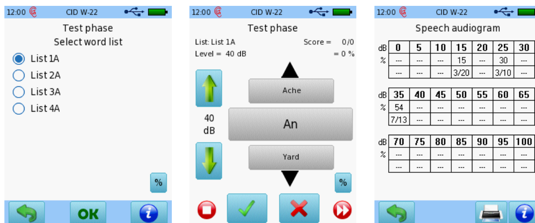
Rys 19: Dostosowanie interfejsu użytkownika UST do określania progów mowy z kontrolą poziomu podczas testowania pojedynczej listy (po lewej - wybór listy; w środku - test z wyborem poziomu i punktacją; po prawej - początkowy widok wyników w postaci ta
