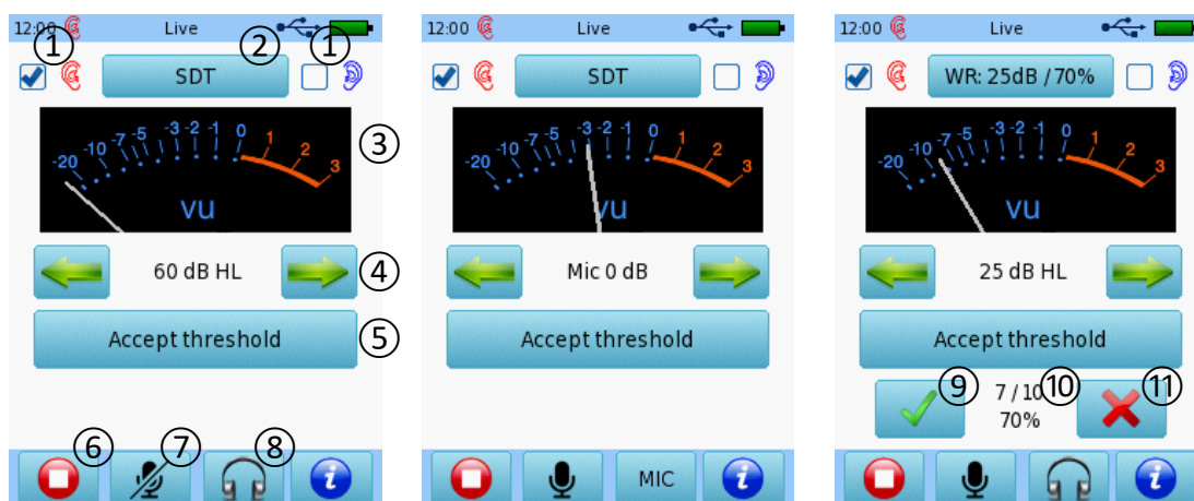
Rys 22: : Interfejs użytkownika funkcji Żywej mowy (po lewej - interfejs użytkownika SDT z wyłączonym mikrofonem; w środku - interfejs użytkownika SDT z włączonym mikrofonem i regulacją poziomu mikrofonu; po prawe j- interfejs użytkownika WR po zaakceptowaniu ok
