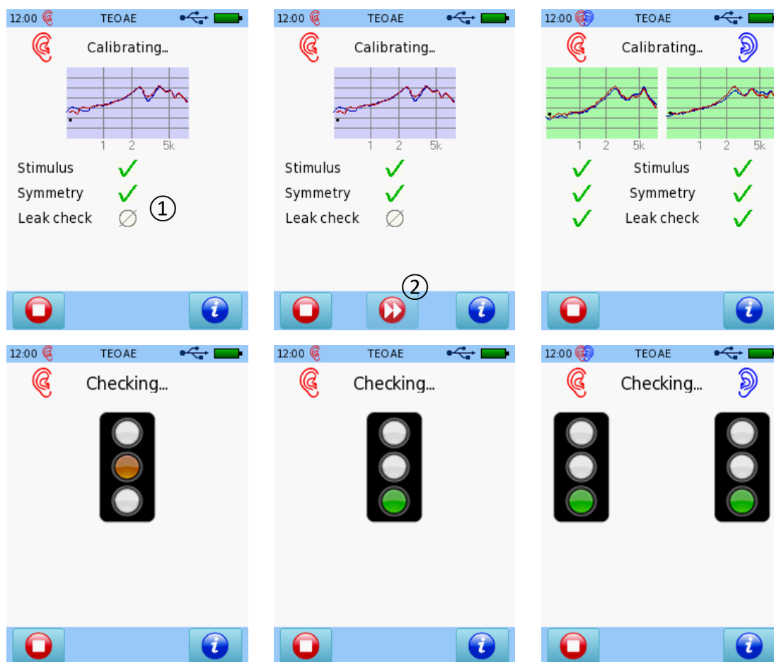
Rys 32: Kalibracja sondy usznej TEOAE (górny lewy - jednouszny tryb ekspercki; górny środkowy - jednouszny tryb ekspercki z opcją pomijania; górny prawy - dwuuszny tryb ekspercki; dolny lewy / środkowy - jednouszny tryb prosty; dolny prawy - dwuuszny tryb prosty)
