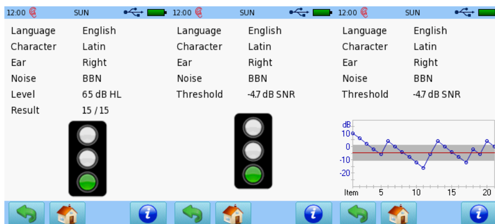
Rys 9: Wyniki SUN (po lewej - SUN Predefined; środek - SUN Adaptive z widokiem sygnalizacji świetlnej; po prawej - SUN Adaptive z widokiem przebiegu czasu SNR)
