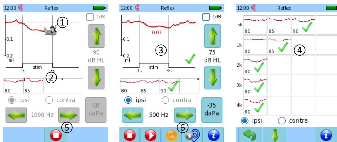
Rys 81: Automatyczny pomiar odruchu strzemiączkowego (po lewej - określenie progu z włączonym trybem kreskówkowym; w środku - tryb ręczny po zakończeniu testu; po prawej - przegląd wyników)
