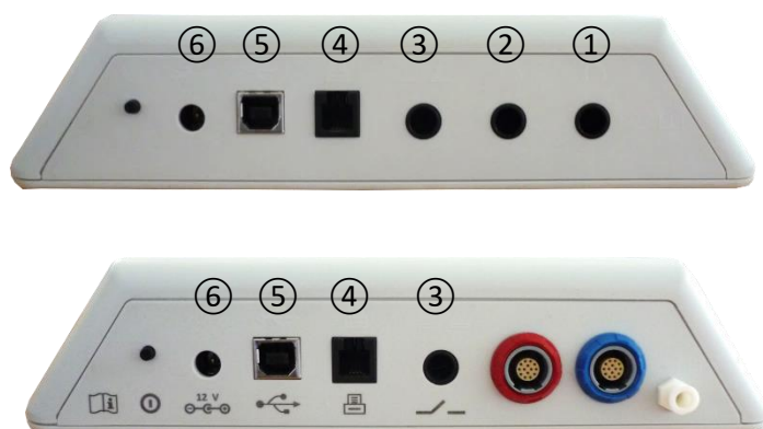
Slika 6: Ploča utičnice desktop uređaja (gore: Senti Desktop, dole: Sentiero Desktop)
