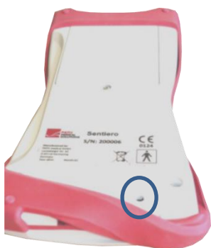
Slika 3: Dugme za resetovanje ručnih uređaja
