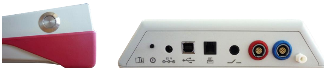
Slika 2: Prekidač za uključivanje/isključivanje za ručni (levo) i desktop uređaj (desno, označen plavim krugom)
