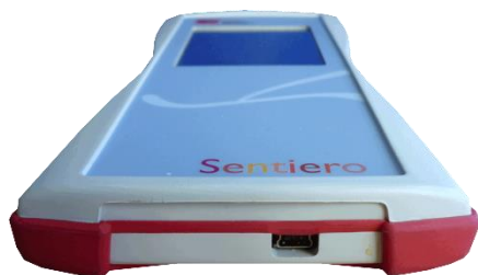
Slika 5: Utičnica za USB kod ručnog uređaja
