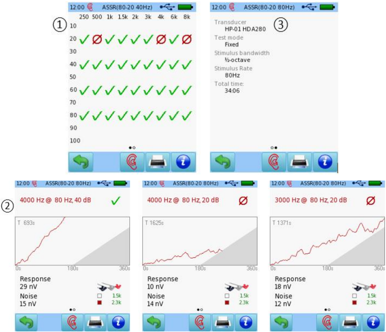
ASSR 结果（左上图：反应状态表；右上图：一般测试信息；下图：有效和无效反应的详细信息）
