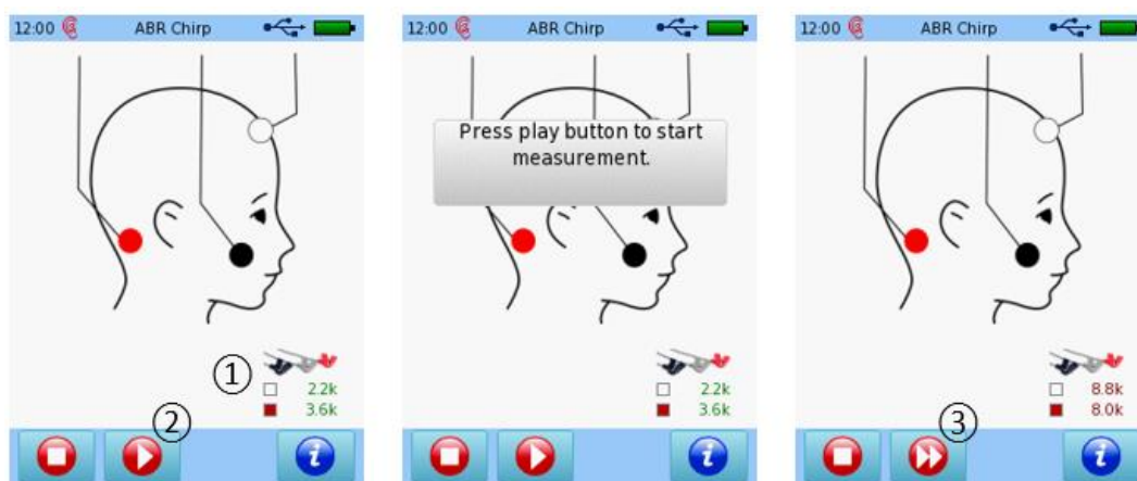
ABR 阻抗测量（左图：阻抗良好，带播放按钮；中图：阻抗良好，带播放按钮并提示按下播放按钮开始测试；右图：阻抗不佳，带继续按钮）
