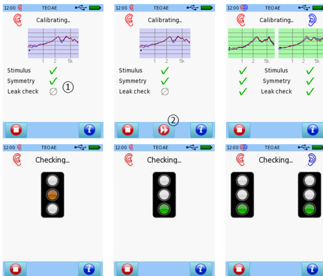
TEOAE 入耳探头校准（左上图：单耳专家模式；中上图：单耳专家模式，带跳过选项；右上图：双耳专家模式；左下图/中下图：单耳简化模式；右下图：双耳简化模式）
