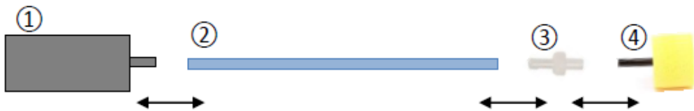
图 2：将发声器单元①组装到声管②、适配器③和耳塞④上（或者从其上拆下来）。
