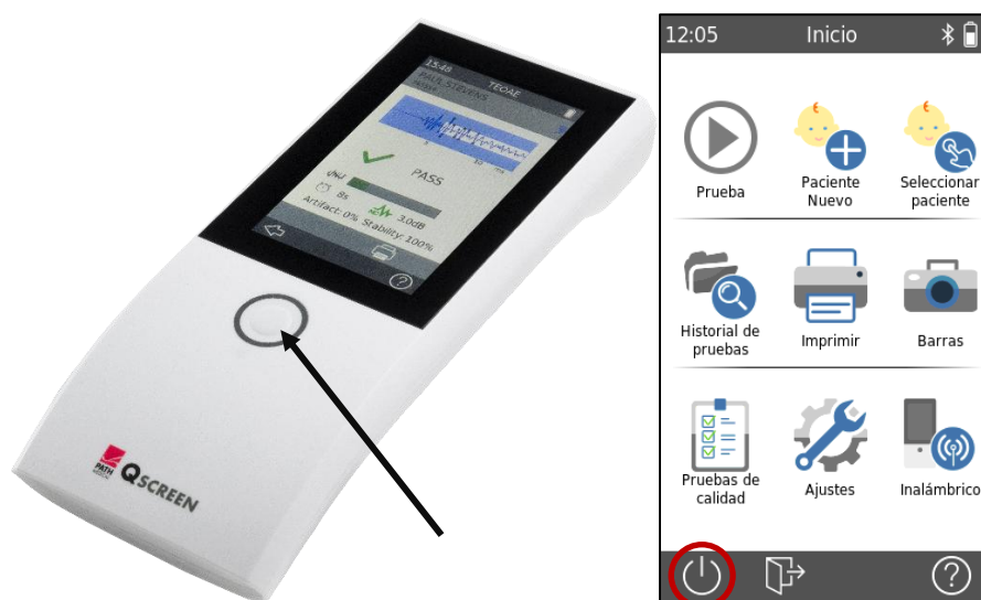
Figura 3: Interruptor de encendido/apagado (izquierda: interruptor de encendido/apagado del equipo, derecha: botón de Apagado)
