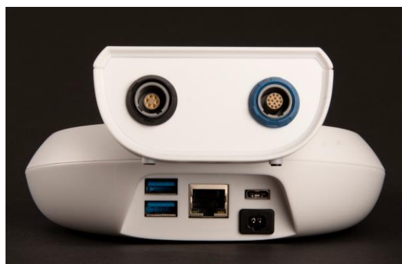
Figura 4: Conectores del equipo QSCREEN (parte superior), conectores de la base de conexión (parte inferior)
