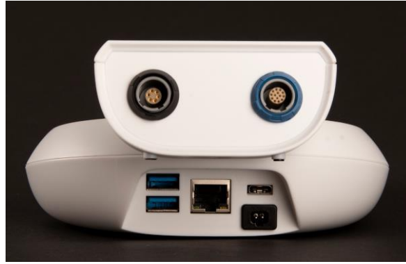
Мал. 4: роз'єми для пристроїв QSCREEN (зверху), роз'єми док-станції (знизу)
