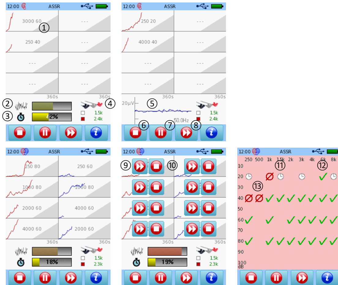
Abbildung 62: ASSR-Messung (oben: monaurale 40-Hz-ASSR-Messung; oben links: Standardmessbildschirm; oben rechts: Messbildschirm mit EEG-Rauschdiagramm; unten: binaurale 80-Hz-ASSR-Messung; unten links: Standardmessbildschirm; unten Mitte: Auswahl Skip/Stop; unten rechts: Messstatus und Ergebnismatrix)
