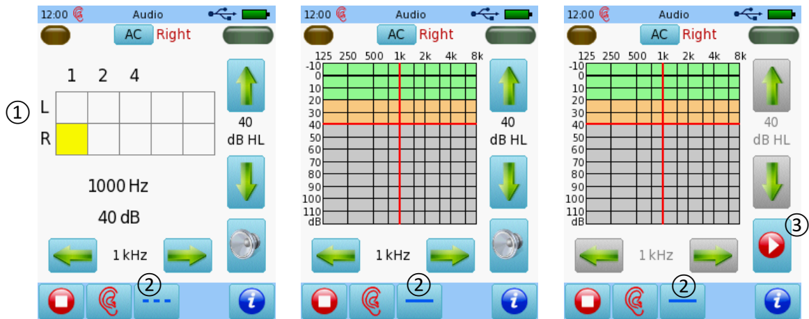
Abbildung 3: Audio-Benutzeroberflächen für verschiedene Protokolle (links: Bildschirm; Mitte: Diagnose; rechts: Auto-Audio)
