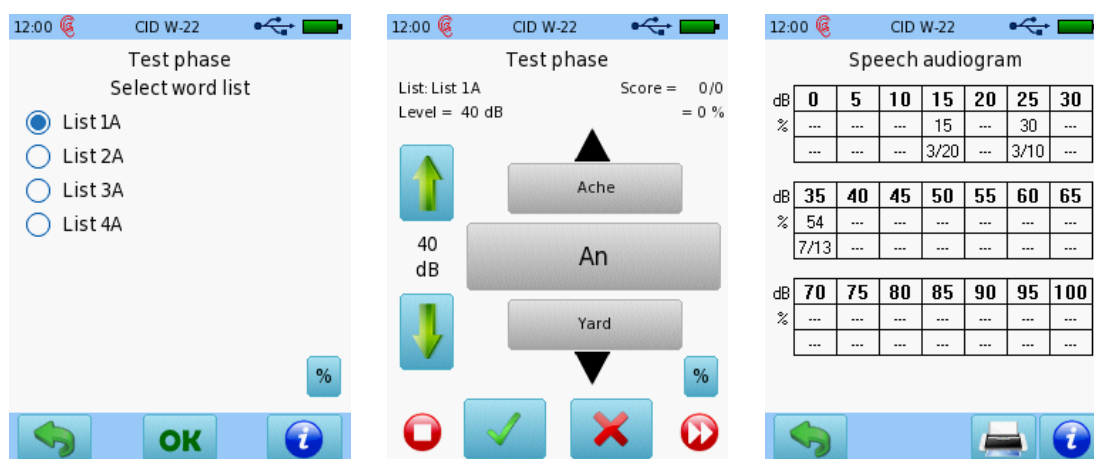
Abbildung 19: Anpassung der UST-Benutzeroberfläche zur Bestimmung von Sprachschwellen mit Pegelkontrolle beim Test einer einzelnen Liste (links: Listenauswahl; Mitte: Test mit Pegelauswahl und Bewertung; rechts: erste Ergebnisanzeige als Tabelle)
