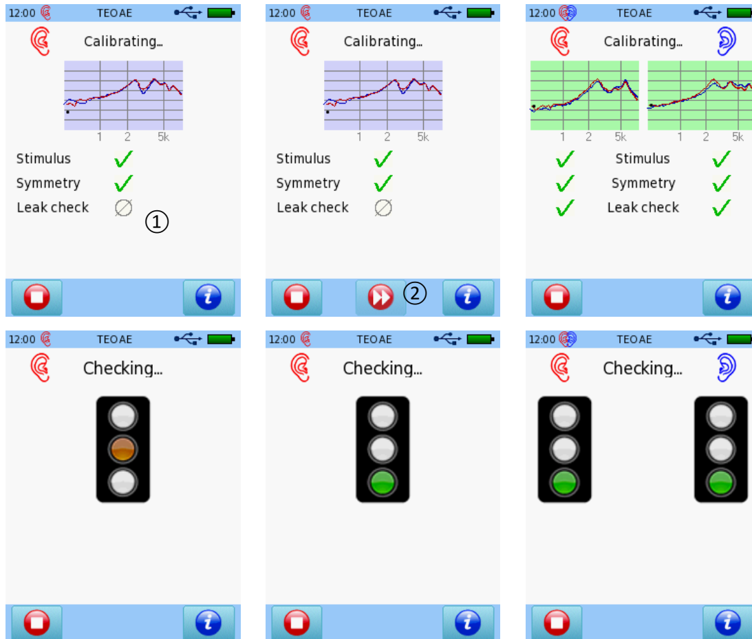
Abbildung 32: TEOAE-Ohrsondenkalibrierung (oben links: Expertenmodus monaural; oben Mitte: Expertenmodus monaural mit Skip-Option; oben rechts: Expertenmodus binaural; unten links/mittig: einfacher Modus monaural; unten rechts: einfacher Modus binaural)
