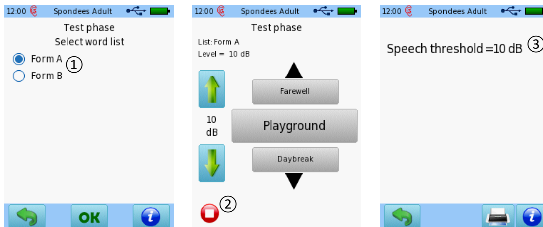
Abbildung 18: Anpassung der UST-Benutzeroberfläche zur vereinfachten Bestimmung von Sprachschwellen (links: Listenauswahl; Mitte: Test mit Stufenauswahl zur Bestimmung der Sprachschwelle; rechts: Ergebnisanzeige)
