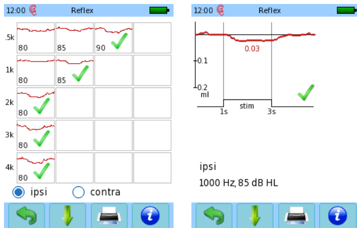
Abbildung 82: Akustisches Reflexergebnis (links: Ergebnisübersicht; rechts: Detailinformationen)
