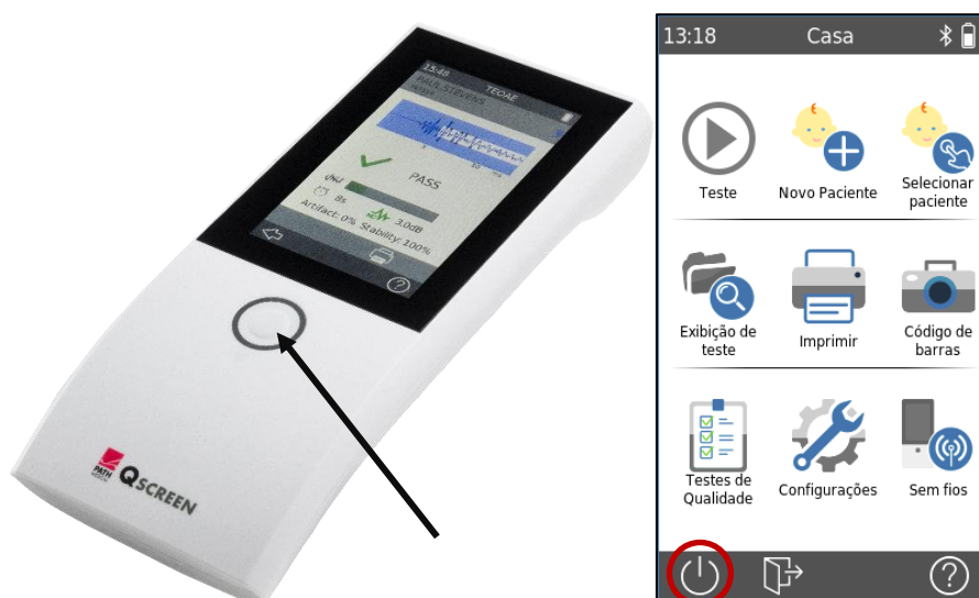
Figura 3: Botão ligar/desligar (esquerda: interruptor ligar/desligar do dispositivo, direita: ecrã Interruptor de Ligar)
