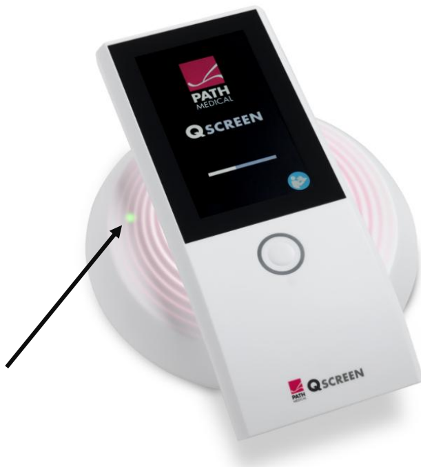
Figura 5: Luz indicadora de carga da estação de acoplamento.
